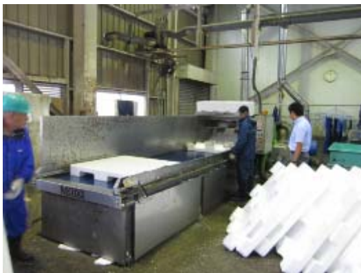
図3-1 処理速度調査（左：大型機による破碎処理、右：小型機による破碎・減容処理）
