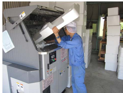
図3-1 処理速度調査（左：大型機による破碎処理、右：小型機による破碎・減容処理）
