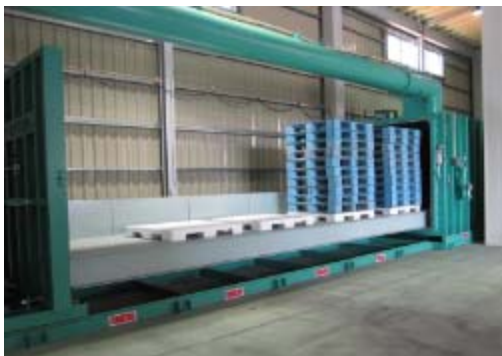
図3-2 真空予冷処理の様子
