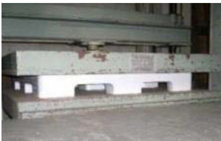
図1-3 室内強度試験における全面圧縮試験の様子(左)と結果グラフ(右)(四方挿し)
