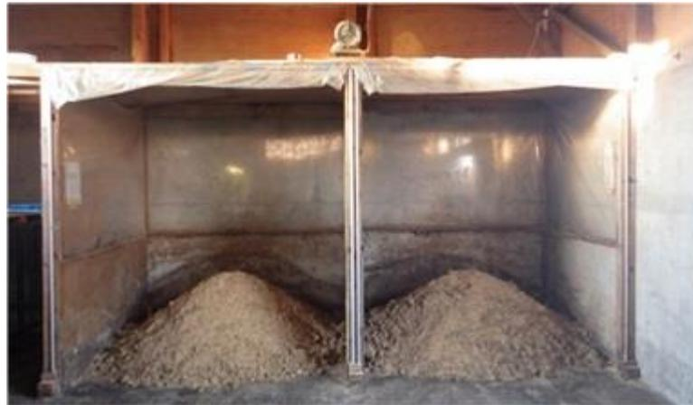
図1 堆肥化試験用チャンバー
