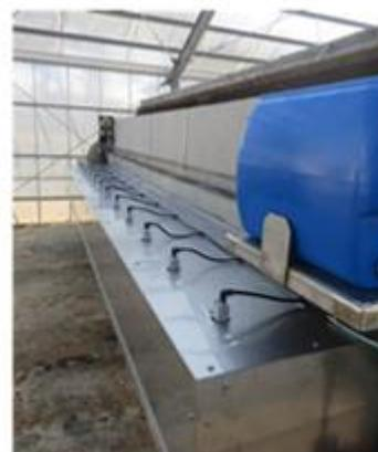
写真1 試作した水散布装置
