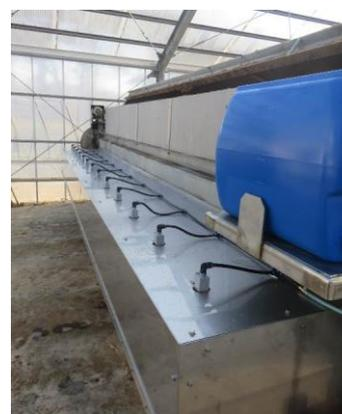
写真1 試作した水散布装置
