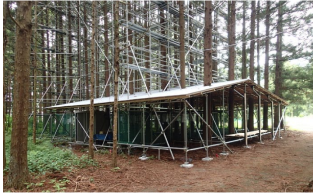
図 2 - 1 林冠観測タワーと降雨遮断のために設置した屋根
