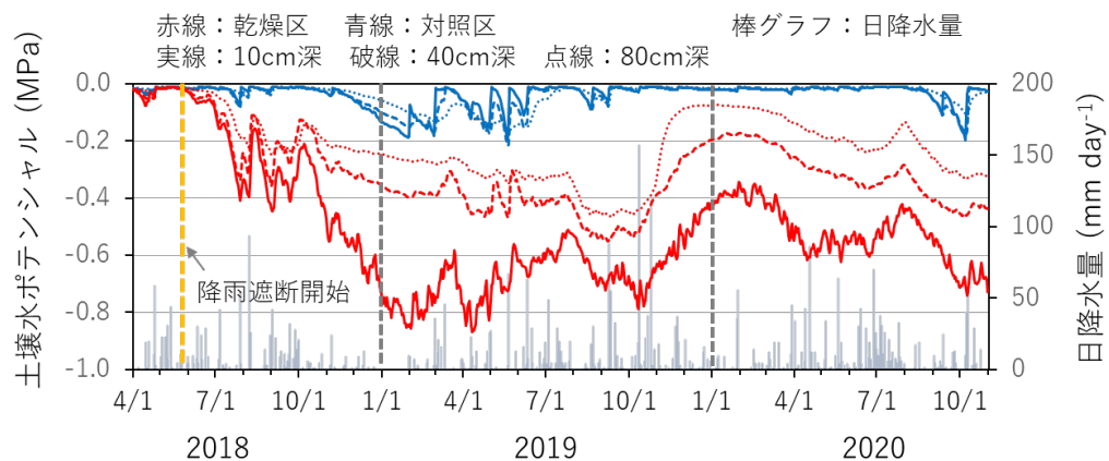
図2-3 土壤水ポテンシャルと日降水量の時間変化(降雨遮断後約3年間)
