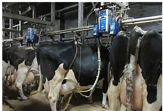
図2 既存の搾乳ユニット自動搬送装置での搾乳作業
