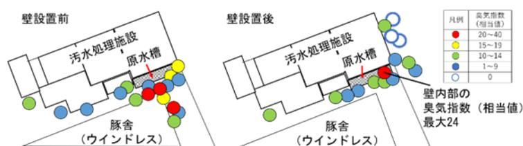
図19 原水槽上部の壁設置による臭気指数相当値への影響
