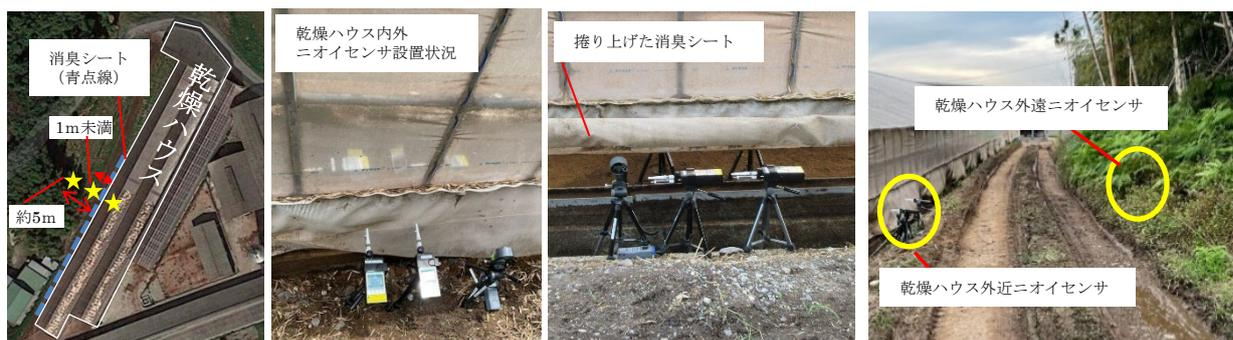
図2 乾燥ハウス側面消臭シート及びニオイセンサ定点計測設置状況
