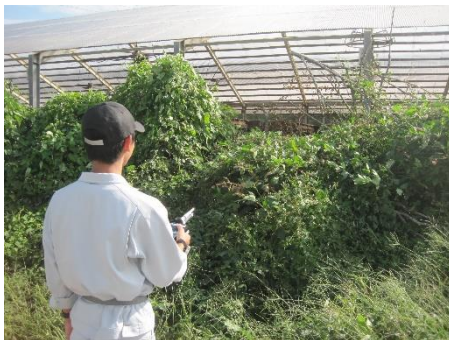
臭気の可視化技術による 臭気計測の様子
