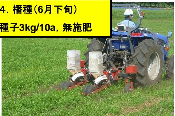
ディスクハロー掛けの4~5日後に、コールターで地面を切り裂くタイプの不耕起播種機でIRG植生中に大豆を播種します。大豆の品種はタチナガハ等の耐倒伏性品種が必須です。
