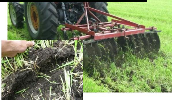
IRGの過剰な再生を抑制するための作業です。植生が反転しない程度のギヤング角とします。
