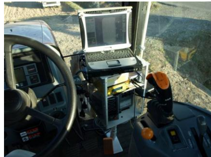
RTK-GPS車載（キャビン内）機器類
