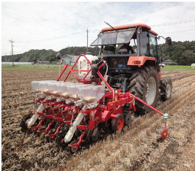
不耕起播種機の外観と播種機構
