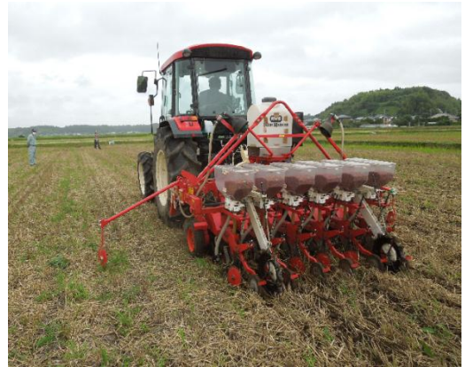
図2 不耕起播種機を用いた大豆の播種作業 (FOEAS圃場により梅雨期においても 十分な排水性と地耐力を確保)
