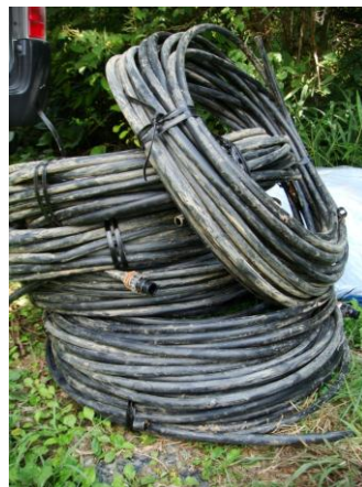
図8 傾斜圃場で散水する場合に適する水圧補正チューブ
