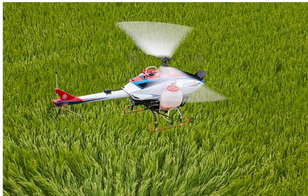
薬剤の粒径及び吐出角度の最適化を行う散布装置を搭載した無人ヘリ
