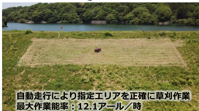
エンジン自動傾斜機能により傾斜地でも走行可能
