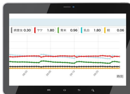
光選別機の被害粒混入率表示例
