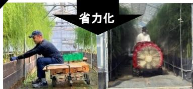
図4. モノレール式作業台車と機械防除
