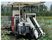
キャベツ収穫ロボット
