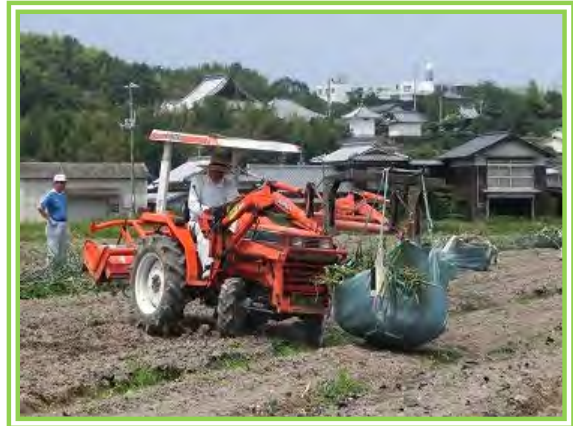
● 新型収穫機で根葉付きのままフレコンに収納し、フロントローダで搬出。
