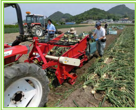
● 新型収穫機で根葉付きのままフレコンに収納し、フロントローダで搬出。
