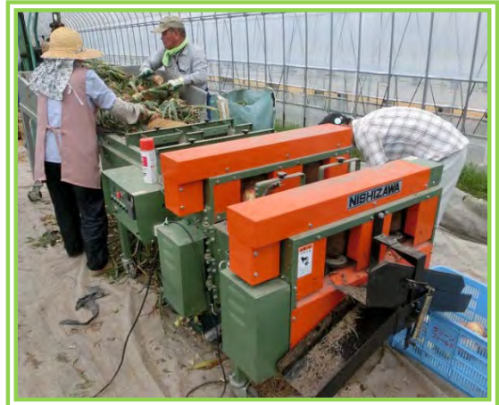
● フレコンから排出し調製機に投入。根葉切り作業の能率は手作業の4倍。
