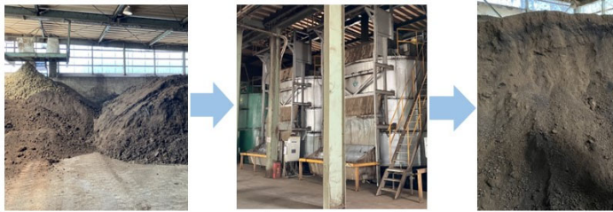
一次発酵(鶏ふん+戻し堆肥) (水分:65~70%) 二次発酵(通気・攪拌) (60℃、2~3日間、水分:60%) 1か月堆積・乾燥 (水分:20~25%)
