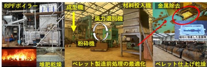
図1 ペレット製造前処理工程等の効率化
