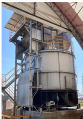
図3 発酵乾燥に利用した密閉縦型堆肥化装置
