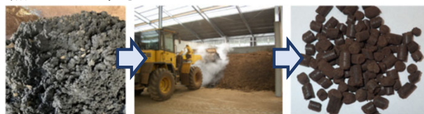
下水汚泥 超高温好気性発酵 汚泥肥料(ペレット)
