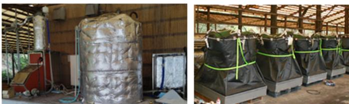
図3 堆肥ペレットの仕上げ乾燥システム
