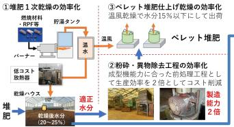
水分を推定し攪拌機を制御し乾燥を制御
