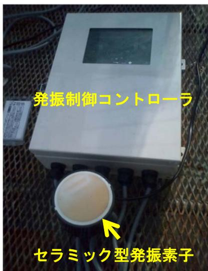
セラミック型超音波発振装置
