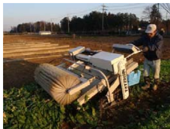
「加工用ほうれんそう収穫機」 手作業と比べて約10倍の 高能率(2.3a/hr)で収穫
