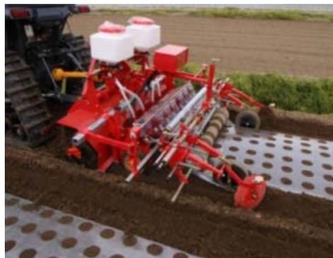
トラクター(播種機)に粒剤散布機・施肥機を設置し、播種時に防除施肥が可能
