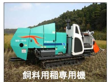
上記①②の収穫機は、いずれも収穫物が細かく切断された高品質なロールベールを形成できるとともに、クローラ式走行部に収穫部と細断型ロールベールを一体化しているため、降雨で地盤が軟弱化しトラクタが入ることが困難になりがちな水田や転換畑、小さな圃場でも作業が可能です。
