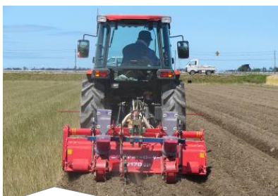
2条用耕うん同時畝立て播種作業機
