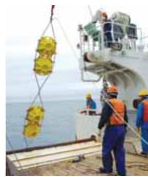
観測機器を固定するための係留系の設置
