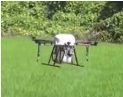
大型ドローンの誤差10cmの飛行制御技術による条間防除、条上防除による野菜作の省力化と農薬節減
