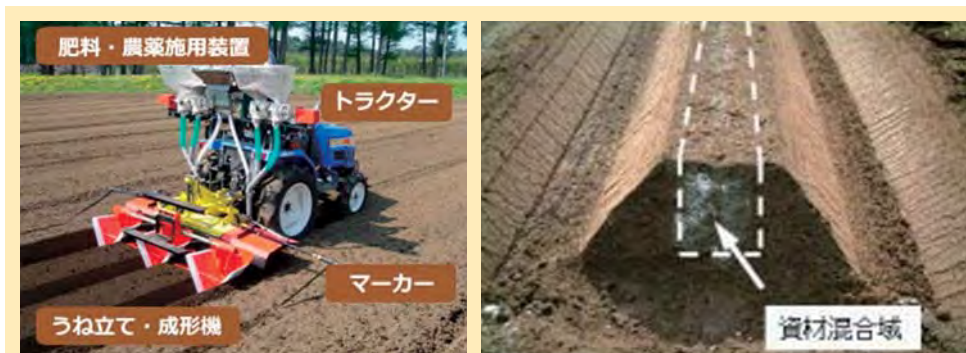
※11 畝内部施肥技術（畝内部施肥機（左）、畝内部施肥の状況（右））
