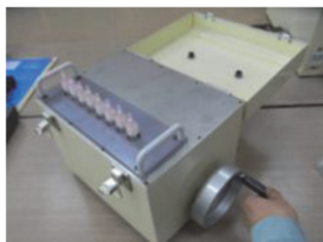
新作した携帯型試料摩碎機
