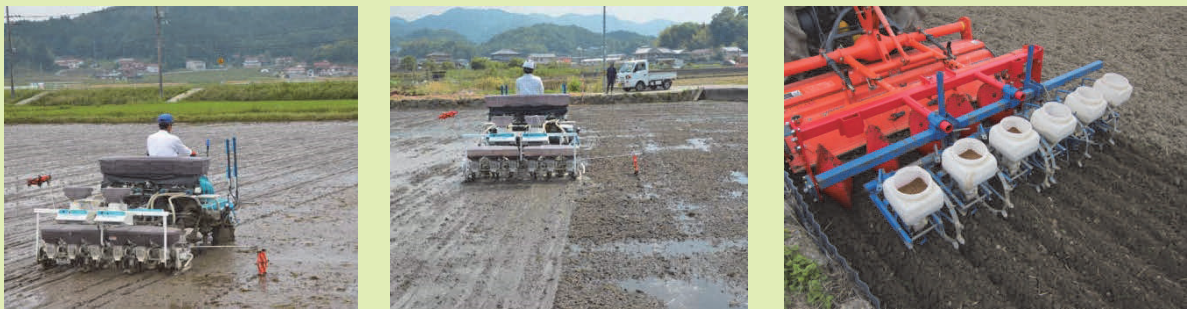
図2 鉄コーティング種子の代かき(左)、無代かき(中央)及び乾田(畦立て)直播(右)。鉄コーティング種子の直播は表面播種であり、特殊な機械を必要としません。生産者は土壌や気象条件に応じて代かき、無代かき、乾田直播を使い分けることができます。本技術の有用性は温暖地湿田地帯、寒冷地及び乾田直播地帯で実証されました。
