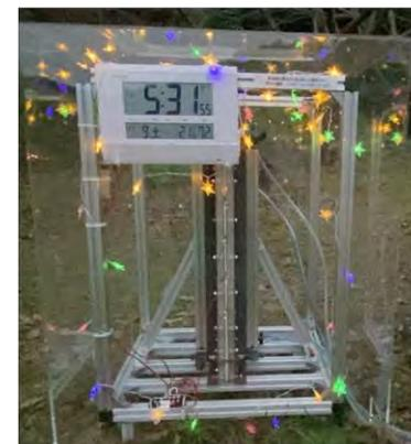
し尿を浄化して水洗用水として循環利用できる自己処理型水洗トイレにトイレ排水の一部を微生物燃料電池の実規模サイズセルに供給。発生させた電力により、それぞれ単三電池3本で動作するデジタル時計とLED電球計60個からなるイルミネーションの稼働を試験。
