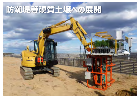
コンテナ苗 自動植栽機 硬い土壌へ完全機械化によるコンテナ苗植栽
