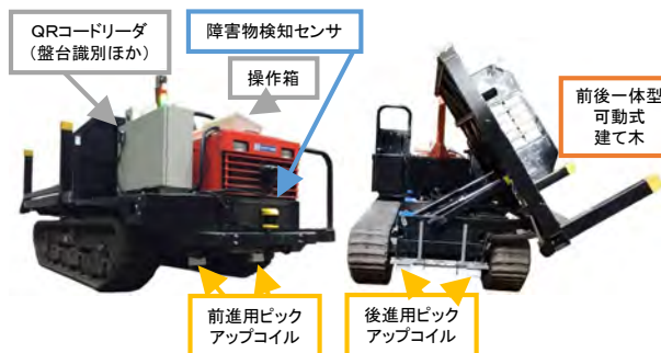
無人運転フォワーダ 誘導電線による自動走行と無人荷下ろし
