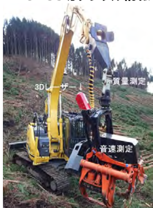
品質測定機能付きハーベスタ 丸太強度を測定し、川下と情報共有
