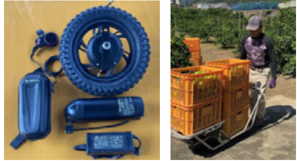
一輪車電動化キットE-cat kitと実装例
