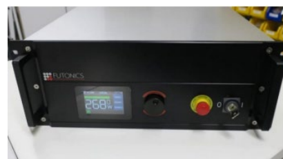
▲レーザ電源の外観
