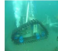
自動で**海底を耕うんしながら酸素を供給**し漁場の回復を図る海底耕うんロボット
