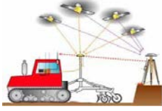
GPSレベラー (衛星からの電波を用いて水田を均平) 均平システム構成(RTK-GPS)
