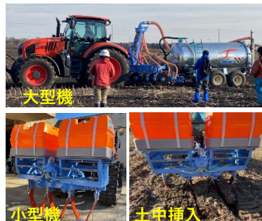
2機種の開発インジェクター機の外観と使用状況
