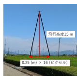
ドローンによる分光反射特性の測定
