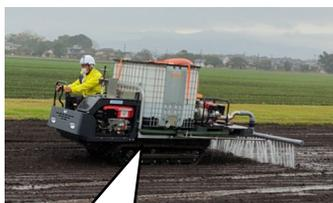
メタン発酵消化液の臭気低減技術の開発では、均一施肥が可能な低コスト散布装置を開発。
