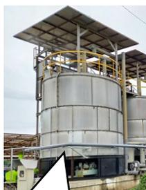
密閉縦型堆肥化装置では通気量の最適化による発酵促進と乾燥処理を行うことで40%程度臭気を低減。
