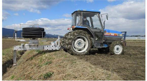
圃場外排水を促す**深い落水口を新設できるトラクタ作業機**を開発。本暗渠等との組み合わせにより、**播種可能日数の大幅な増加と小麦・大豆1割以上収量の向上**を確認
