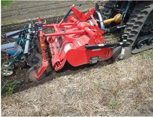
アップカットロータリによる浅耕とサイドディスクによる溝切を播種と同時に行う**一工程浅耕播種機**を開発。**作業速度、大豆収量の3割向上**を確認
