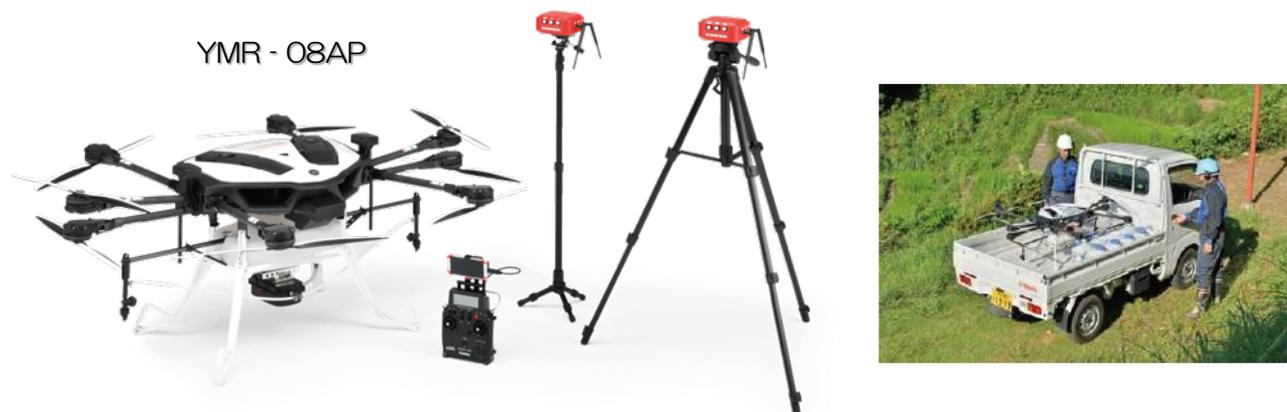
**ヤマハ発動機（株）製ドローン YMR-08AP**は強いダウンウォッシュを発生する上下二重反転ローターと最適配置された散布ノズルを装備し、同社製無人ヘリに匹敵する散布品質を示すことから傾斜地果樹園を自動航行する農薬散布ドローンのベース機体として選定した。
