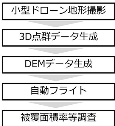
▲ ドローン散布試験の流れ
