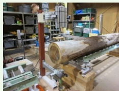
ガンマ線による丸太測定
