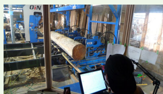
簡易測定システムによる形状測定
