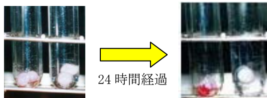
図1 リパーゼの作用による内皮膜の崩壊 リパーゼは外皮膜に 0.05%添加
