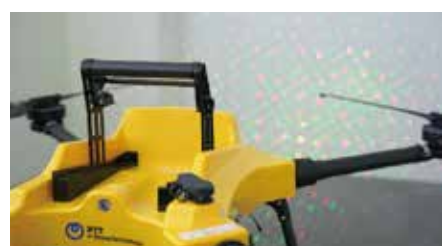
ドローンから複雑なパターンでレーザーを照射することで、慣れを防止し、効果を持続
