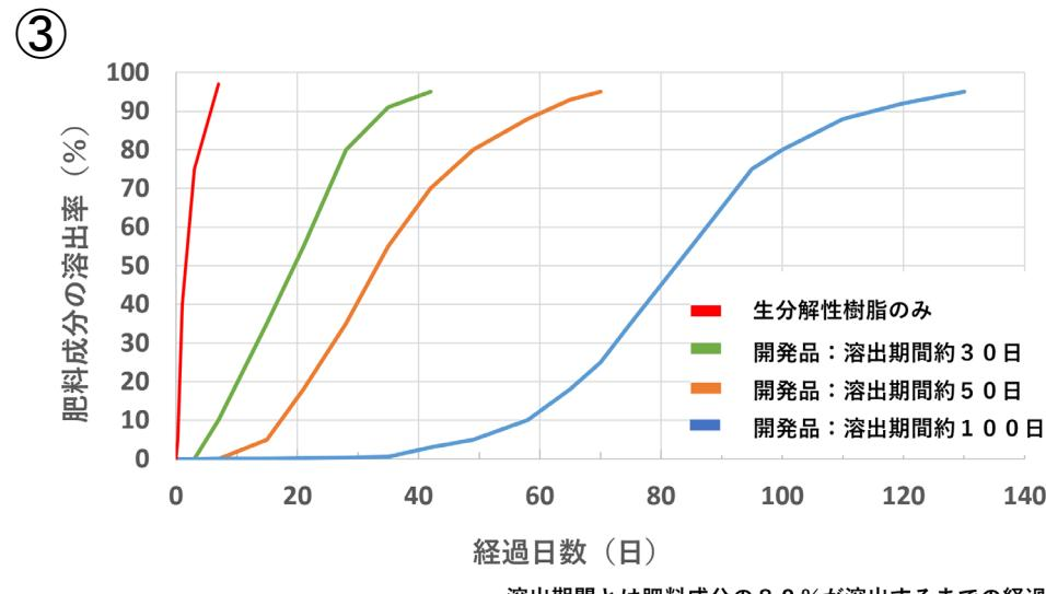
③開発した被覆材による肥料成分の溶出挙動。利用者の要望に合わせて、肥料成分の溶出期間を制御することが可能に。
