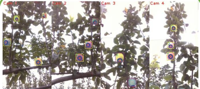
ロボットに取り付けたカメラにより果実を認識(写真中口が認識された果実)。2次元画像だけではなく、距離計測も行うことで、果実の着果位置を把握。日中・夜間に関わらず90%以上の精度を達成。
