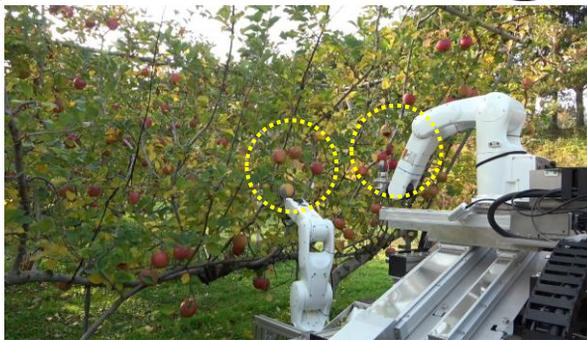
リンゴ・ニホンナシ・セイヨウナシを対象に果実を傷つけずにハンドの回転により収穫するロボットアーム・ハンドを開発。作業速度向上のため2本のアームを使用し、お互いの動きを理解して接触しないように作業を行うことで、人と同様の作業速度(11秒/個)を達成。
