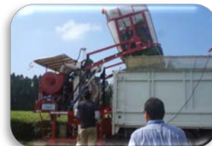
遠隔操作で機体に 乗らずに安全作業
