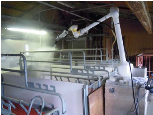
分娩豚舎用ロボット アームの関節が多く、分娩ストールの洗浄といった複雑な動きが可能。
