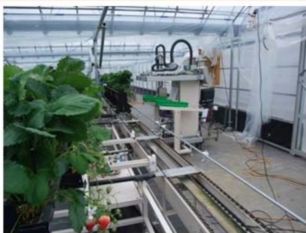
定置型収穫ロボットと 循環式移動栽培装置を連動
