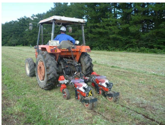
開発機による不耕起ほ場での播種作業
